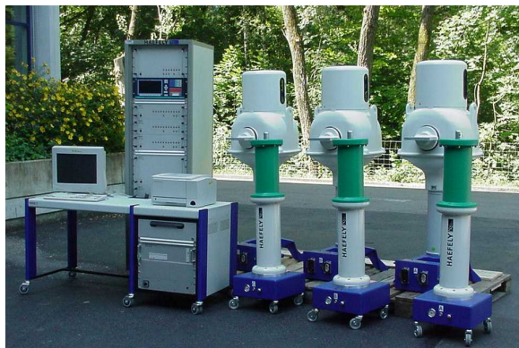
電力用変圧器ロス測定システム 型式TMS580-100-4000
